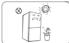
Избегайте попадания прямых солнечных лучей и воздействия источников тепла. Во избежание коррозии и нарушения электрической изоляции, не устанавливайте холодильник во влажном помещении или помещении, где он может контактировать с водой.
